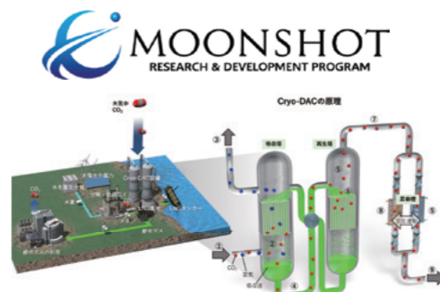
今回、開発を目指す技術(Cryo-DAC ※4 )を核とするカーボンサイクル ※5 (イメージ図)
